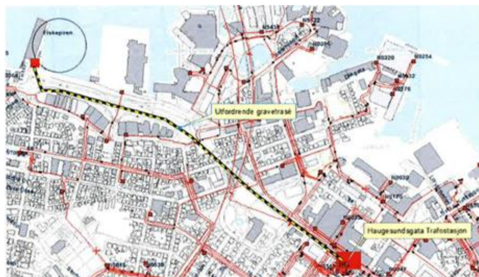
Figur 17 Alternativ kabelfrømføring fra Haugesundsgaten transformatorstasjon til Fiskepiren
