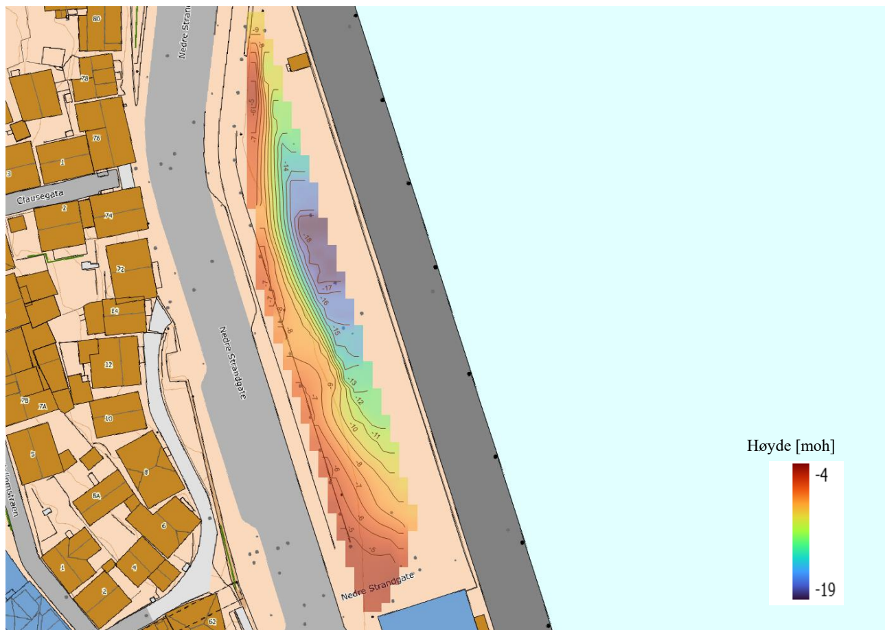
Fig 14. Høydekart grunnfjell med kotelinjer hver 1m.
