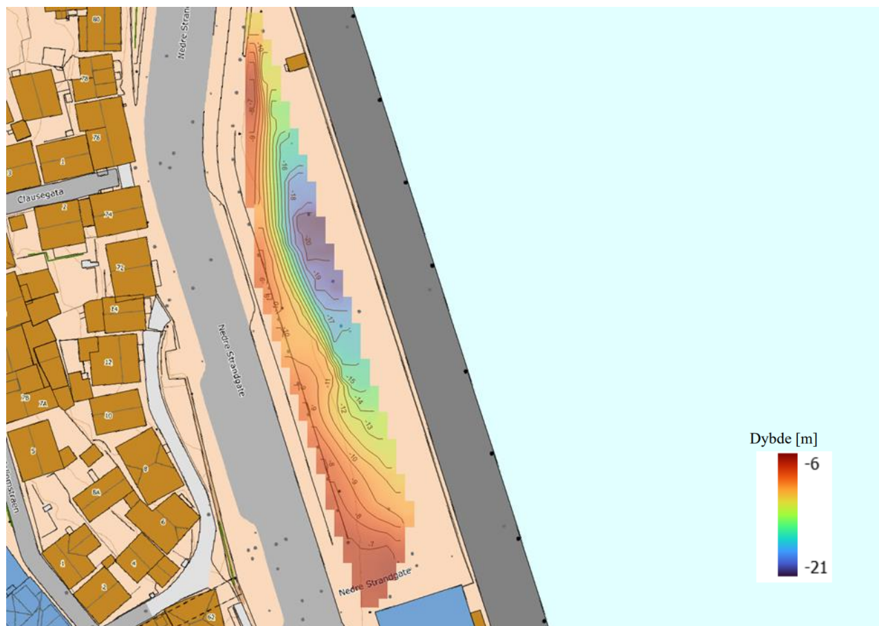
Fig.15. Dybdekart grunnfjell med kotelinjer hver 1m
