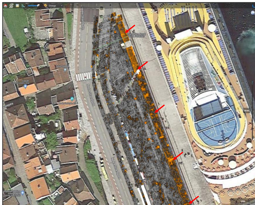
Fig 22. Kanten av kaien -tolking eksempel på StreamC dataene
